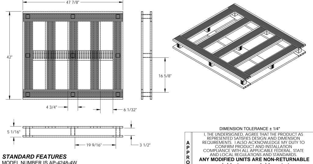
MODEL NUMBER IS AP-4248-4W **OVERALL WIDTH IS 42" OVERALL LENGTH IS 47 7/8" OVERALL HEIGHT IS 5 1/16"** MAX STATIC CAPACITY IS 6.000 LBS MAX DYNAMIC CAPACITY IS 4,000 LBS MAX UNSUPPORTED CAPACITY IS 4,000 LBS TOP SLAT WIDTH IS 4 3/4" WELDED ALUMINUM CONSTRUCTION
